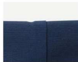
オーバーラップ接着 接着代の厚み1.15mm
